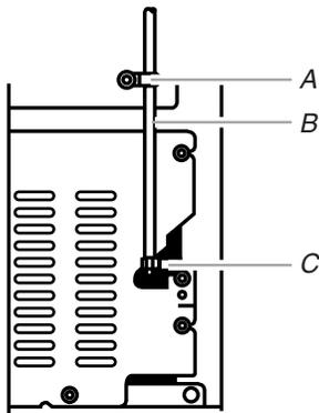
A. Bride du tube C. Écrou de compression
