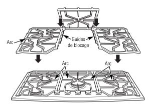
Modèle ZGU385: replacez les deux grilles latérales de façon à ce que leurs guides de blocage soient dirigés vers la grille centrale afin que les membrures centrales des trois grilles forment un « arc » continu. Assurez-vous que la grille centrale est verrouillée par-dessus les guides des grilles latérales et que toutes les grilles sont stables et de niveau.
