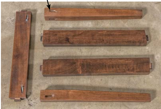
mortis & tenon construction
