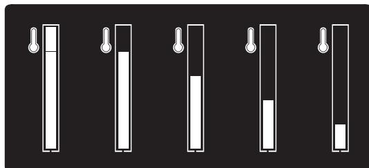
La barra de la temperatura desaparecerá cuando la temperatura de la cavidad del horno sea inferior a 140°F (60°C).
