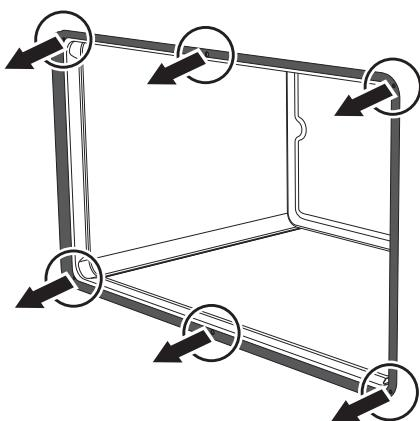
La empaquetadura debe ser blanda y elástica. Para limpiar la empaquetadura, utilice una esponja no abrasiva y lave con agua tibia.
