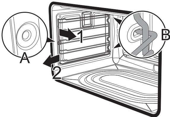
1. Una vez completada la limpieza, repita los pasos anteriores para volver a colocar los soportes de los estantes.
