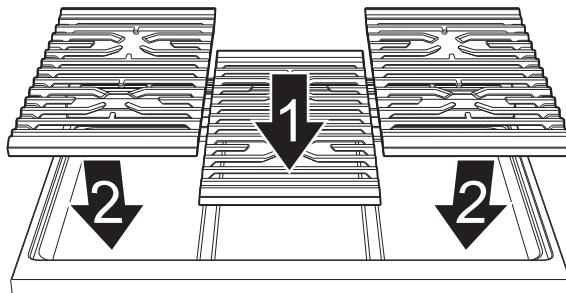
Coloque las rejillas de manera que la parte levantada siempre esté orientada hacia el respaldo.
