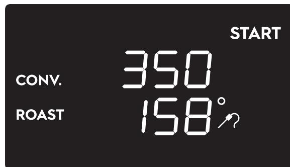
3. Presione la perilla de la temperatura del horno para cambiar la temperatura de la cavidad del horno. La pantalla mostrará la temperatura predeterminada de la cavidad en la parte inferior con el símbolo de los grados intermitente. La palabra “+” desaparece.
