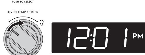
Una vez configurada la hora, la pantalla pasa al modo de espera en el que solo se muestra la hora actual. Para ajustar el reloj de la pantalla tras el ajuste inicial, en la modalidad stand-by, mantenga presionada y gire la perilla de la temperatura hacia la izquierda o hacia la derecha durante al menos 3 segundos, hasta que parpadeen los dígitos de las horas.
