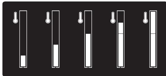
Cuando se ha completado el precalentamiento, los segmentos de la barra de la temperatura y el ícono
