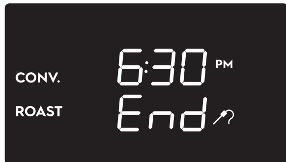
Gire y suelte el botón del modo del horno para detener el avisador acústico y la función. La pantalla pasa a la modalidad de espera.
