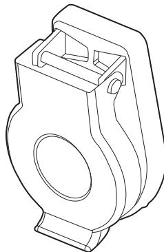
Se utiliza para cubrir y proteger la toma de corriente de la sonda de temperatura cuando esta no se utiliza.
