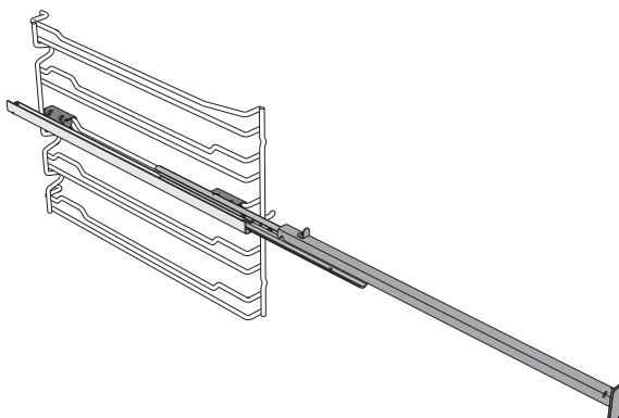
Cuando utilice las guías, extráigalas completamente y coloque con cuidado la rejilla sobre ellas.
