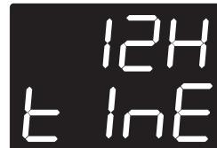
Al girar la perilla de la temperatura hacia la derecha, la pantalla cambia entre el formato de 12 horas (con la indicación AM/PM) y el formato de 24 horas.
