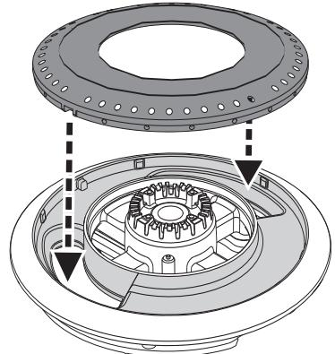
3. La tapa del quemador debe estar nivelada y centrada con respecto al zócalo del quemador.
