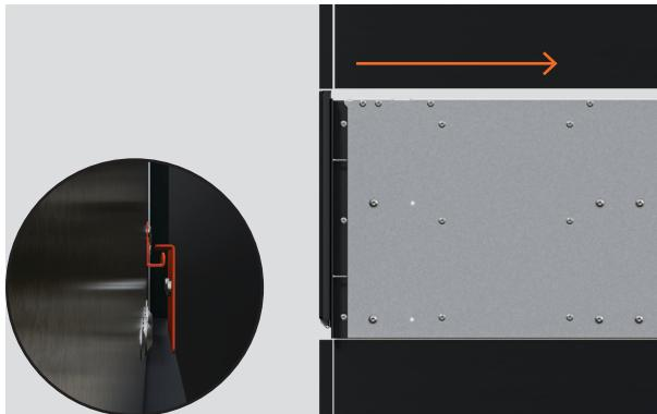
3. Con cuidado, empuje el cajón de vacío dentro del gabinete. Asegúrese de que los soportes laterales se acoplen con los soportes antivuelcos.
