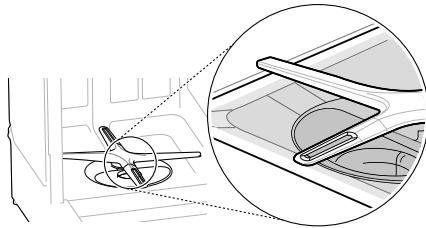
Tras extraer la bandeja inferior, coloque un nivel en la pared interior de la cuba para verificar que el lavavajillas esté nivelado de lado a lado.
