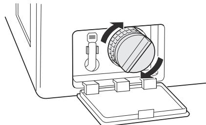
**8** Cierre la cubierta del filtro de la bomba de desagüe.
