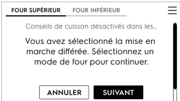
3. Appuyez sur **SUIVANT** et faites défiler Modes du four jusqu'à **Autonettoyage**. Suivez les informations à l'écran pour régler la durée du délai et la durée de l'autonettoyage.
