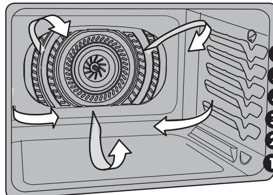
Figure 4: Rôtissage à convection sur les grilles du four inférieur
