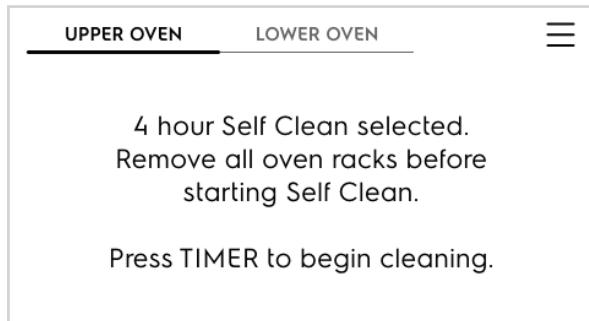
Lorsque le four est réglé au cycle d'autonettoyage, le loquet motorisé de la porte commencera à verrouiller la porte du four. N'ouvrez pas la porte du four lorsque le moteur de verrouillage est en marche ou lorsque des indicateurs de verrouillage ou des messages sont affichés. La porte du four sera complètement verrouillée après environ 15 secondes. Lorsque la porte est verrouillée, NETTOYAGE s'affiche pour indiquer que le four va commencer le processus d'autonettoyage.
