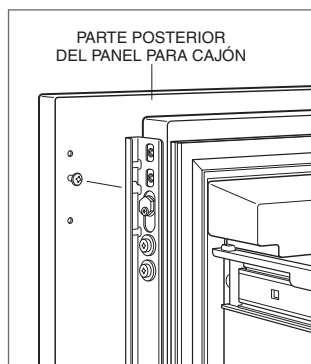
Montaje del panel del cajón
