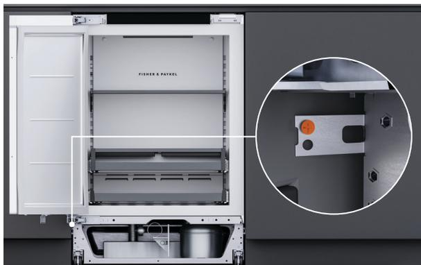
3. À l'aide d'une vis cruciforme courtes fournies, fixez le côté inférieur gauche du produit à la cavité.
