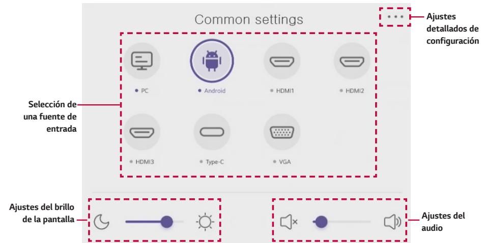
Si selecciona • • • en la parte superior derecha de la pantalla, puede fijar los elementos necesarios para utilizar la pizarra digital interactiva, además de los dispositivos de entrada/salida. Puede mover cada pantalla de configuración al pulsarla a los lados.
