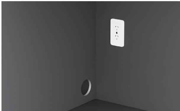
**5.** La prise électrique doit être accessible après l'installation pour l'entretien.
