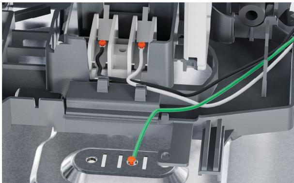
8. Fixez les câbles sous tension (noir) et neutre (blanc) au bloc de jonction. Fixez le câble de terre (vert) au châssis.
