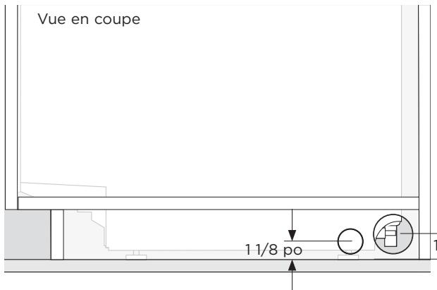
2. Le centre du trou de service doit se situer à au maximum 1 1/2 po du plancher ou du bas des pieds du lave-vaisselle.
