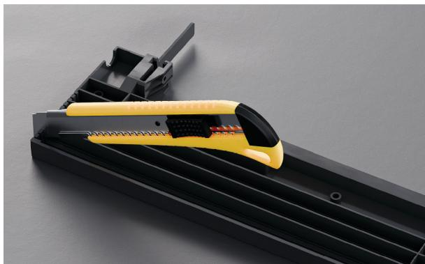
**3.** Incisez le coup-de-pied des deux côtés avec un couteau à lame rétractable sur une surface protectrice.
