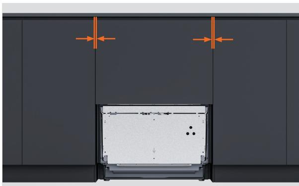
2. Soustrayez de chaque mesure l'espace nécessaire entre les panneaux de l'armoire. L'espace minimum requis entre les portes ou tiroirs d'armoires adjacentes est de **1/16 po**.
