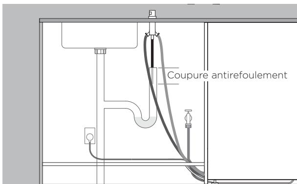
La méthode d'installation avec coupure antirefoulement double est recommandée.
