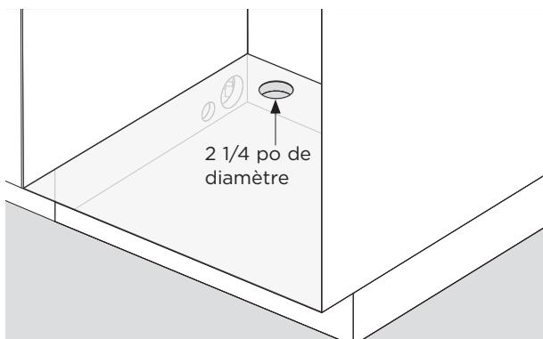
3. Un trou de service de 2 1/4 po de diamètre est requis dans l'étagère de l'armoire adjacente.
