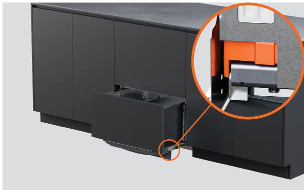
6. Remettez la cuve sur les glissières, tirez les attaches de verrouillage vers l'avant et enclenchez le tiroir en place.
