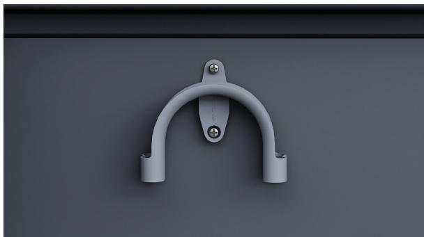
**1.** Installez le support du tuyau d'évacuation aussi près que possible du plan de travail, à une distance minimale de 29 1/2 po du plancher
