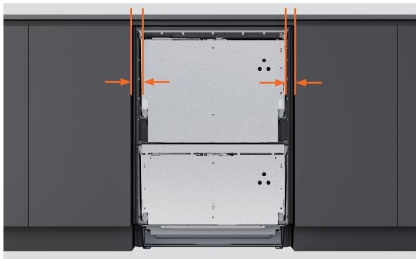
1. Mesurez la distance entre les portes d'armoire adjacentes et les bords du support de porte
