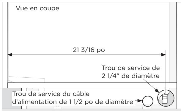
1. Un trou de service d'un diamètre minimum de 2 1/4 po est requis dans le côté de l'armoire.
