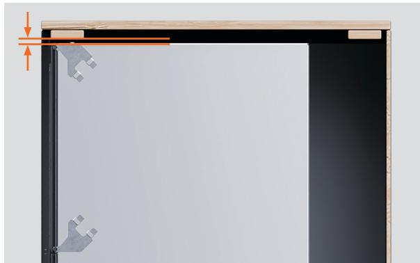
3. Réglez la hauteur du lave-vaisselle entre 1/8 et 3/16 po sous la hauteur de la cavité.
