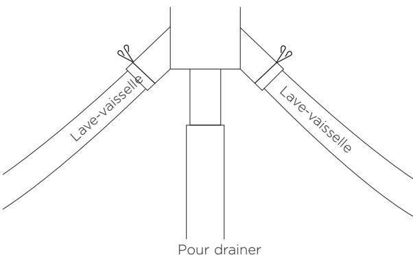
2. Insérez les attaches métalliques sur les tuyaux avant d'installer les deux tuyaux sur l'ensemble de coupure antirefoulement double.
