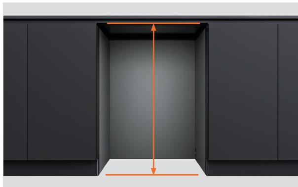
2. Mesurez la distance entre le plancher et le dessous du plan de travail ou du cadre de la cavité.
