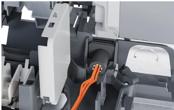
**6.** Coupez prudemment le câble à l'intérieur **et** à l'extérieur du moulage de décharge de traction pour retirer le câble.
