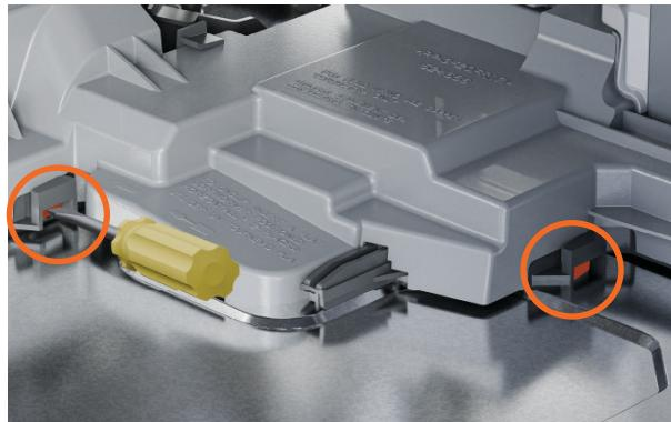
**3.** À l'aide d'un tournevis à pointe plate, enfoncez les clips et faites glisser le couvercle d'accès vers l'extérieur.
