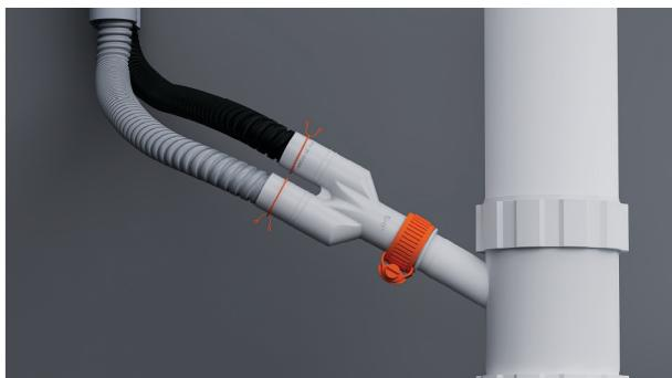
**3. Insérez les attaches métalliques sur les tuyaux.**
