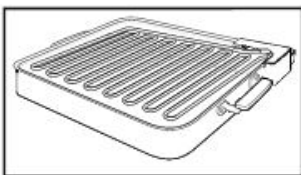
Plateau inférieur et élément de chauffage d'accessoire alimenté
