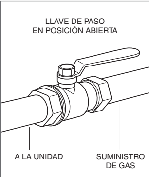
Llave de paso del suministro de gas
