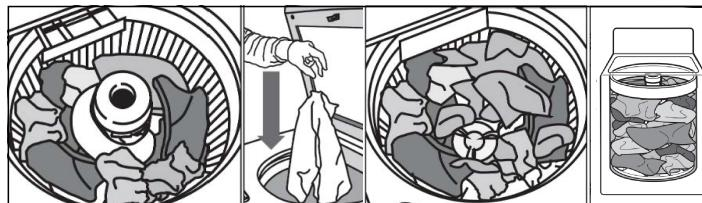
Pour un meilleur rendement, déposer les articles de lavage de façon uniforme autour de la paroi du panier. Ne pas poser d'articles dans le sens de la longueur.
