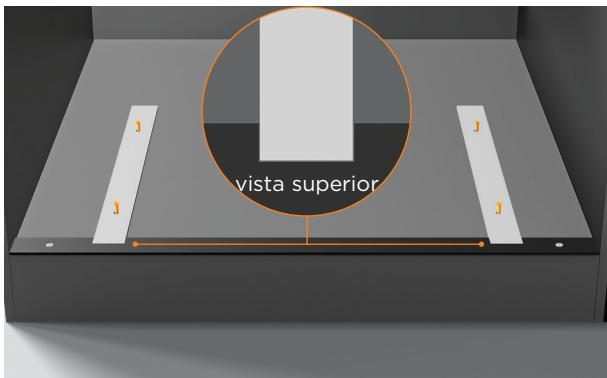
2. Encaje los dos separadores laterales en su lugar. Asegúrese de que los separadores estén espaciados uniformemente en la parte delantera y trasera de la cavidad.
