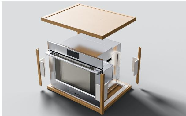
**1.** Corte todas las correas y retire la tapa de la caja. Levante la funda de la caja y retire el embalaje de transporte. Aparte los accesorios.
