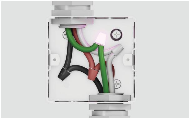
**6.** Conecte el cable de conexión a tierra verde del horno al cable de conexión a tierra (verde) de la caja de conexiones. No conecte el cable de conexión a tierra verde al cable neutro (blanco) en la caja de conexiones.
