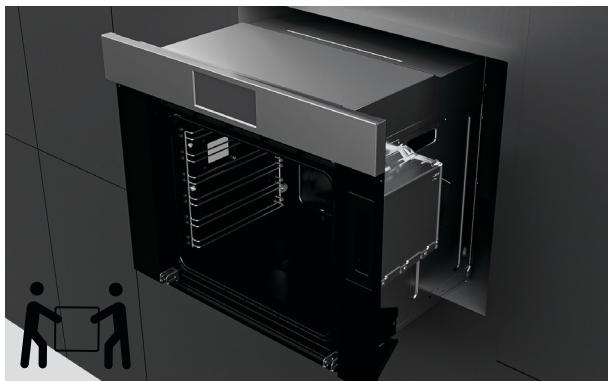
1. Asegúrese de que el tanque de agua esté asegurado en su lugar. Coloque el producto en la cavidad, asegurándose de no levantarla del panel de control.
