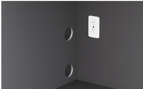
**5.** La prise électrique doit être accessible après l'installation pour l'entretien.
