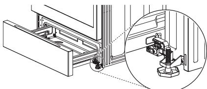
**2** Si hay tornillos **1** en los laterales de la parte posterior del cajón, remueva los 2 tornillos y apártelos. Para los modelos sin tornillos, vaya al paso 3.
