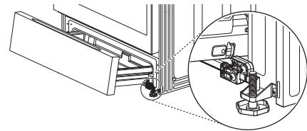
**4** Si el cajón tenía tornillos, inserte y apriete los 2 tornillos **1** en los lados de la parte posterior del cajón.
