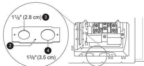
Para instalaciones con cable de alimentación ⑤, enganche el pasacables sobre el orificio para cable de alimentación de 1 3/8 pulg. (3.5 cm), ubicado por debajo de la parte trasera del horno. Inserte el cable de alimentación a través del pasacables y ajústelo.
