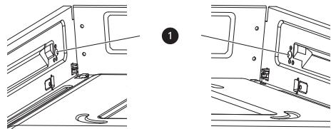
**3** Levante la parte delantera del cajón hasta que los topes salgan de las guías.
