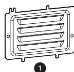
Utilice la placa de conexión del cable/conducto ② para instalar el cable de alimentación o el conducto. Deje la placa de conexión como estaba instalada para las instalaciones del cable de alimentación. Retire la placa de conexión para las instalaciones de conductos y gírela para utilizar el
