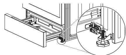
**3** Levante la parte frontal del cajón, y empújela hacia atrás hasta que los topes se desenganchen de las guías, y baje la parte frontal del cajón.
