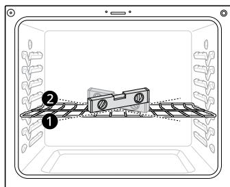
**2** Si el nivelador no queda equilibrado sobre el estante, ajuste las patas de nivelación con una llave.
