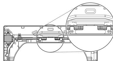
**10** Revierta el soporte de la bisagra inferior **3** y el ensamble de la bisagra **10**.
