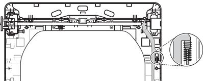
**6** Retire 2 tornillos y el soporte del eslabón superior **9**. Coloque el soporte del eslabón superior **9** y el tornillo a un lado.
