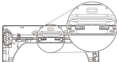
**7** Levante y retire el relleno de la bisagra superior **11** (a la derecha) y colóquelo a un lado.
