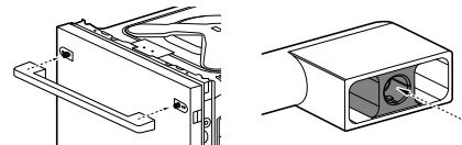
**3** Para fijar la nueva manija en su sitio, colóquela sobre las fijaciones de montaje tal como se muestra y apriete los tornillos de fijación.
