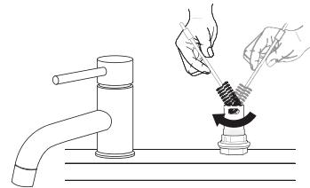
**4** Vuelva a colocar la tapa plástica y la cobertura de la trampa de aire.
