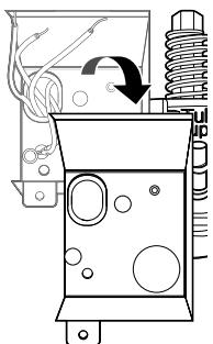
**5** Inserte un aliviador de tensión **2** de 3/8" a través del orificio de la caja de empalmes. Apriete la tuerca redonda **3** para asegurararlo en su sitio.
