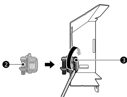
**6** Inserte el cable eléctrico a través del orificio del aliviador de tensión. Ajuste los 2 tornillos para asegurararlo.
