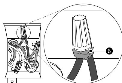
**10** Pliegue los cables conectados, intodúzcalos nuevamente dentro de la caja de empalmes y atornille la cubierta de la caja.
