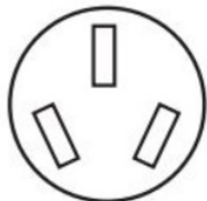
Tomacorriente de 3 hilos (10-50R)
