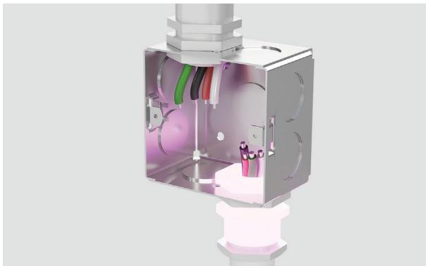
2. Connectez le câble du four à la boîte de jonction via le connecteur confit homologué UL.
