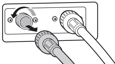
**4** Enchufe el cable de alimentación en un tomacorriente correctamente conectado a tierra.
