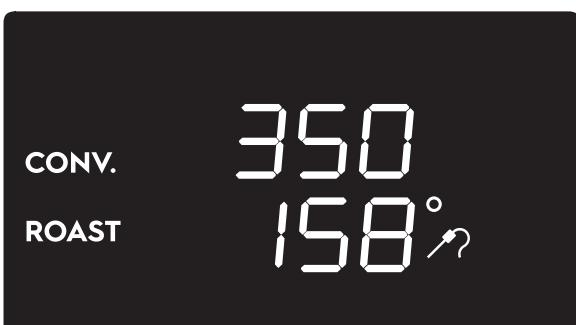
6. Gire la perilla de la temperatura del horno para cambiar la temperatura objetivo de la sonda.
