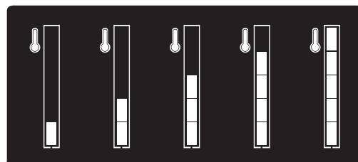
Cuando se ha completado el precalentamiento, los segmentos de la barra de la temperatura y el ícono
