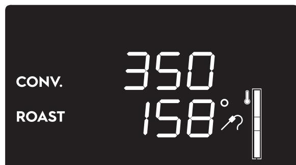
1. Presione la perilla de la temperatura de horno para cambiar la cavidad del horno y la temperatura objetivo de la sonda para carne, tal y como se hizo al programar el ciclo de cocción.
