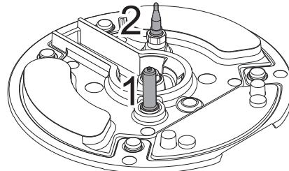
Consulte la sección «Instalar los quemadores» cuando vuelva a montar los componentes del quemador.
