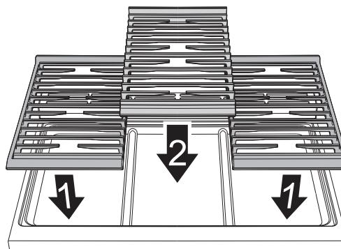
Coloque las rejillas de manera que la parte levantada siempre esté orientada hacia el respaldo.
