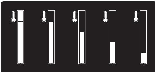
La barra de la temperatura desaparecerá cuando la temperatura de la cavidad del horno sea inferior a 140°F (60°C).
