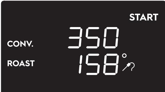
3. Presione la perilla de la temperatura del horno para cambiar la temperatura de la cavidad del horno. La pantalla mostrará la temperatura predeterminada de la cavidad en la parte inferior con el símbolo de los grados intermitente. La palabra «**START**» desaparece.
