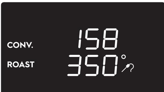
4. Gire la perilla de la temperatura del horno para cambiar la temperatura de la cavidad.
