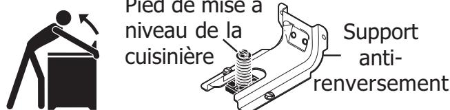
Pour vérifier si le support anti-renversement est correctement installé, attrapez le bord arrière de la cuisinière à deux mains. et essayez doucement de faire basculer la cuisinière vers l'avant. Lorsque le support est correctement installé, la cuisinière ne doit pas basculer vers l'avant.
