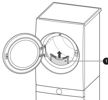
Asegúrese siempre de que el filtro de pelusa esté instalado correctamente antes de poner en funcionamiento la secadora. Hacer funcionar la
