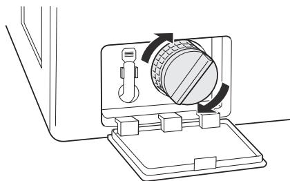
**8** Cierre la cubierta del filtro de la bomba de desagüe.
