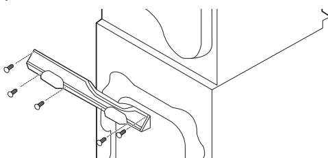
**3** Presione los tapones de los lados derecho e izquierdo del panel de control de la parte delantera del artefacto para abrirllos. Afloje los tornillos que se encuentran debajo de los tapones.
