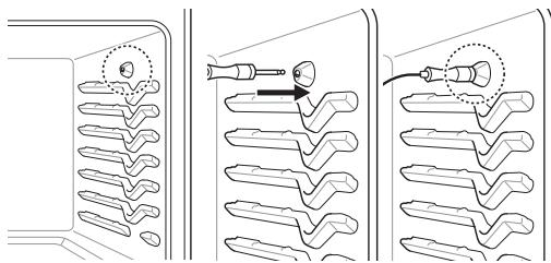
**3** Si la sonda para carne está conectada correctamente, el ícono de la sonda para carne parpadea en la pantalla.
