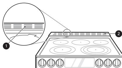
① Ventilación del horno
