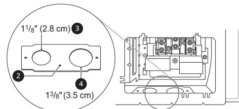
Para instalaciones con cable de alimentación ⑤, enganche el pasacables sobre el orificio para cable de alimentación de 1 3/8 pulg. (3.5 cm), ubicado por debajo de la parte trasera del horno. Inserte el
