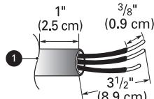
① Placa de conexión del cable/conducto
