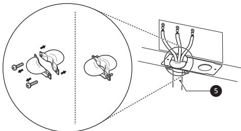
Para instalaciones de conductos, inserte el pasacables del conducto en el orificio correspondiente de 1 1/8 pulgadas (2.8 cm). Luego, instale el conducto a través del cuerpo del pasacables y ajústelo con su anillo.
