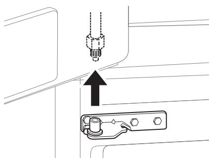
**2** Rote la palanca de la bisagra **3** hacia la derecha. Libere la bisagra superior **4** del picaporte de la manija de la bisagra **5**.
