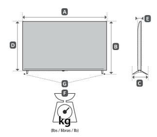
**MODELS** Power consumption C F-G B E D **MODELOS** Consumo de potencia MODÈLES Consommation électrique mm (inches / pulgadas / po) kg (lbs / libras / lb) 961,3 6.48 961.3 613 613 214.6 214,6 563.5 563,5 74.1 74,1 6,48 6.42 6,42 43UM340E0UZ 100 W (37.8)(37,8)(24.1) (24,1) (8.4)(8,4)(22.1) (22,1) (2.9)(2,9)(14.2) (14,2) (14.1) (14,1) Power requirement / Alimentación requerida / Alimentation électrique AC 100-240 V~ 50/60 Hz
