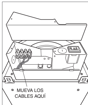
Ubicación del cableado
