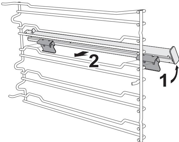
2. Gire las guías para bloquear la parte inferior del gancho en la parte inferior del soporte del estante.
