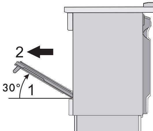
3. Para volver a montar la puerta, coloque las bisagras en las ranuras del horno correspondientes, asegurándose de que las secciones acanaladas **A** queden apoyadas completamente en las ranuras. Baje la puerta y, una vez en su lugar, quite los pernos de los
