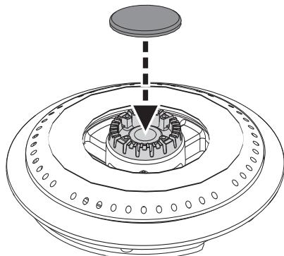
Todos los componentes del quemador deben colocarse de manera horizontal y encajar correctamente entre sí.
