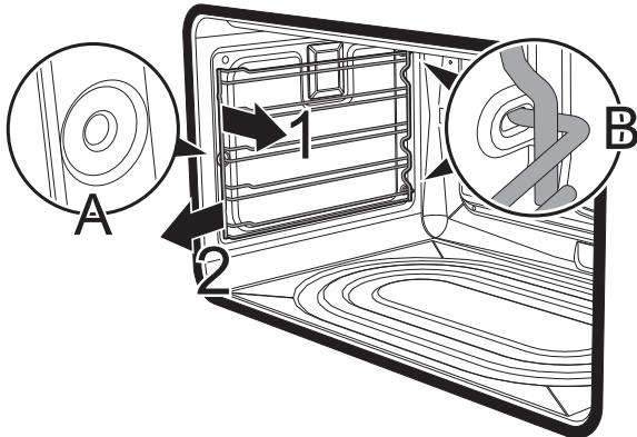
1. Una vez completada la limpieza, repita los pasos anteriores para volver a colocar los soportes de los estantes.
