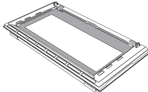
4. Vuelva a colocar los vidrios siguiendo la secuencia del desmontaje en forma inversa. Vuelva a posicionar el vidrio interior. Centre e inserte cuidadosamente los 4 pernos en sus ranuras en la puerta del horno ejerciendo una
