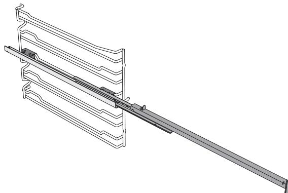
Cuando utilice las guías, extráigalas completamente y coloque con cuidado la rejilla sobre ellas. Procure colocar la rejilla sobre las guías tal y como se muestra en la siguiente figura.
