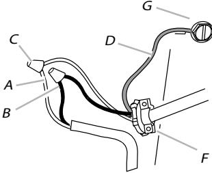
2. Use conectores de cables que estén en la lista de UL y conecte los alambres blancos (A) juntos.
