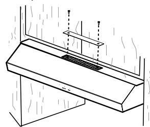
**NOTA:** Para instalaciones que descargan el aire hacia el techo o la pared, la tapa recirculante debe permanecer en su lugar o este no funcionará correctamente.
