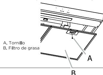
2. Para retirar el filtro, deslice el seguro hacia el frente y jale hacia abajo la parte frontal del filtro.
