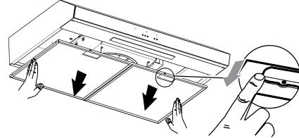
3. Retire las varillas del filtro de carbón y extraiga el filtro de carbón (situado en la parte posterior del filtro de grasa).
