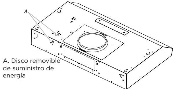
4. Con la ayuda de 2 o más personas, levante la campana y colóquela en su posición final. Haga pasar suficiente cable eléctrico a través del protector de cables de  $\frac{1}{2}''$  que esté en la lista de UL o aprobado por CSA para hacer las conexiones en la caja de terminales. Apriete los tornillos del protector de cables.
