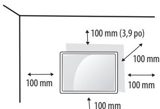
Assurez-vous d'utiliser les vis et les fixations murales qui répondent aux normes VESA. Les dimensions standard des trousse de fixation murale sont indiquées dans le tableau suivant.
