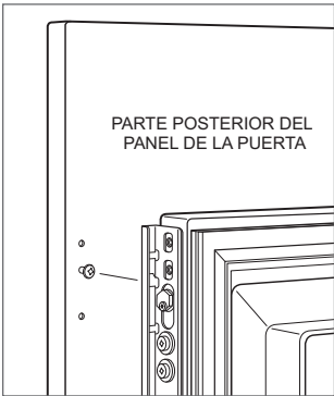
Montaje del panel de la puerta
