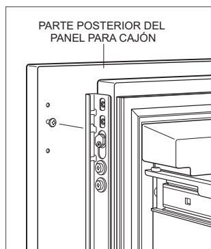
Montaje del panel del cajón
