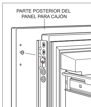
Montaje del panel del cajón
