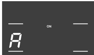
3. Maintenez le bouton enfoncé et sélectionnez le niveau de puissance requis dans les 3 secondes. L'afficheur de la zone de cuisson correspondante indiquera
