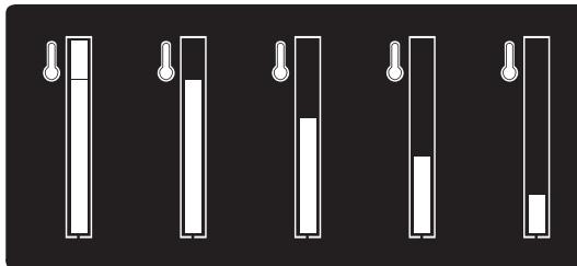
La barre de température disparaît lorsque la température de l'intérieur du four passe en dessous de 140 °F (60 °C).
