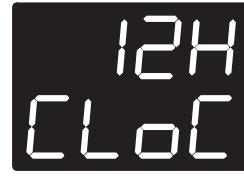
En tournant le bouton de température vers la droite, l'afficheur bascule entre le format 12h (avec l'indication AM / PM) et le format 24h.
