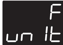
En tournant le bouton de température vers la droite, l'afficheur bascule entre °C et °F.
