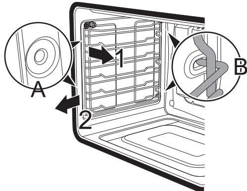
1. Lorsque le nettoyage est terminé, répétez les procédures ci-dessus pour réinstaller les cadres.
