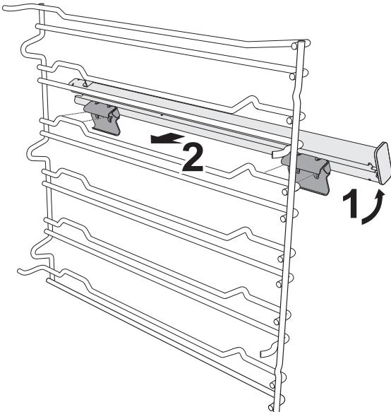
2. Tournez les guides pour verrouiller la partie inférieure du crochet sur la partie inférieure du support de plaque.
