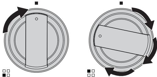
Les deux afficheurs de la zone de cuisson indiquent maintenant le niveau 0 et des points rouges clignotants apparaissent sur tous les afficheurs. La fonction Bridge (Couplage) est maintenant activée.
