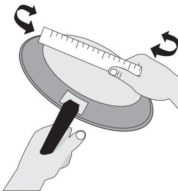
Vérifiez la planéité en faisant tourner une règle sur le fond de la batterie de cuisine. La batterie de cuisine devrait avoir un fond plat qui assure un bon contact avec toute la surface de l'élément chauffant.
