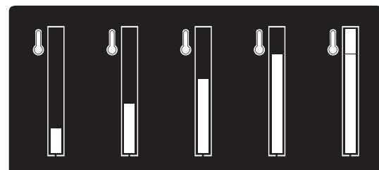
Lorsque le préchauffage est terminé, les segments de la barre de température et l'icône
