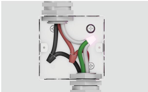
5. Connectez les fils vert et blanc du four, fixés en usine, au fil neutre (blanc) de la boîte de jonction.
