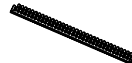
Protecteur de rebord (1) (Si le trou des raccordements se trouve dans une cloison métallique, vous devez apposer le protecteur de rebord fourni pour éviter d'endommager le cordon d'alimentation ou les tuyaux.)
