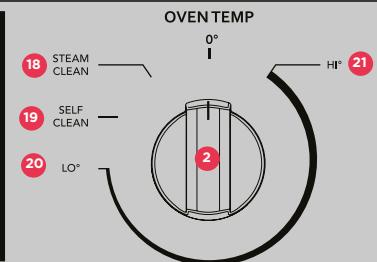
14. La fonction **CLEAN MODES** permet de régler un cycle d'autonettoyage.
