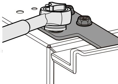
16. Conecte los terminales del interruptor de puerta a la cubierta de la bisagra superior. Atornille la cubierta de la bisagra superior en su lugar.
