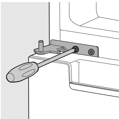
15. Reemplace la puerta superior. Coloque la puerta en la bisagra central y alinéela con el refrigerador asegurándose de que las juntas de la puerta queden bien sellados con el refrigerador. Fije firmemente la bisagra superior al refrigerador.
