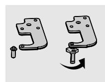
5. Mueva el interruptor de puerta de la cubierta de la bisagra derecha a la cubierta de la bisagra izquierda (bolsa de accesorios).
