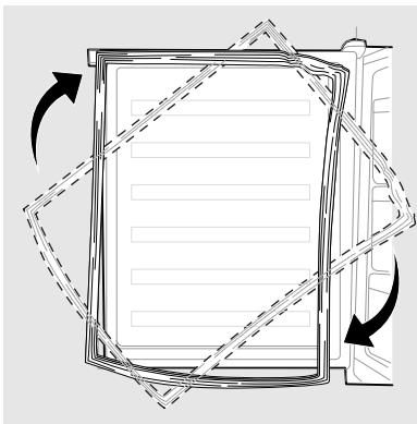
14. Instale la puerta inferior, ajuste y fije la bisagra central en el refrigerador.
