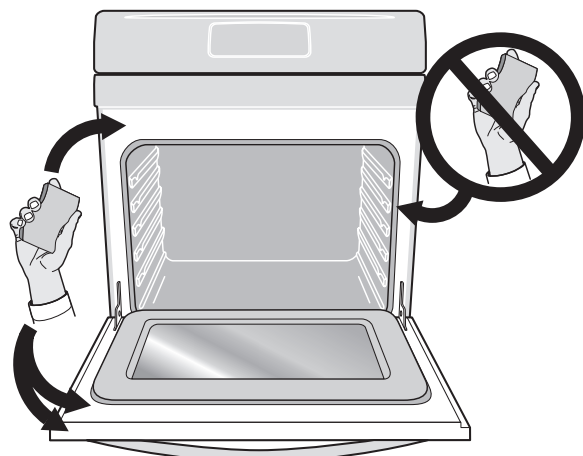
Figure 6: Nettoyer le pourtour du joint de la porte du four
