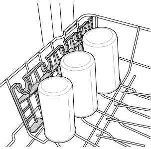
**2** Ubique la ranura del ensamble **1** en la bandeja para tazas, haga coincidir la ranura con la barra, y con firmeza haga salir la barra de soporte de ese lado.
