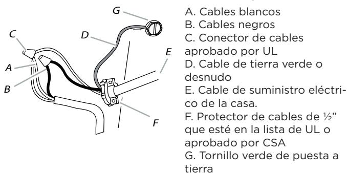
2. Use conectores de cables que estén en la lista de UL y conecte los alambres blancos (A) juntos (**hay dos cables blancos en la campana, ambos deben estar conectados a la fuente de alimentación**).
