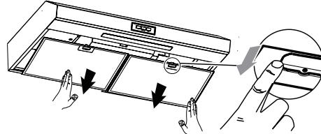
3. Retire las varillas del filtro de carbón y extraiga el filtro de carbón (situado en la parte posterior del filtro de grasa).
