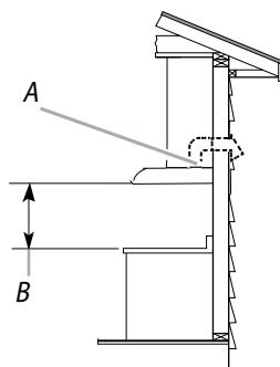
A. Ventilación redonda de 7" (17,8 cm) a través de la parte superior (se adquiere por separado)
