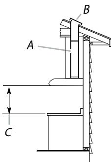
A. Ventilación redonda de 7" (17,8 cm) a través del techo.
