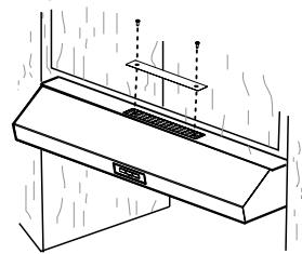
**NOTA:** Para instalaciones que descargan el aire hacia el techo o la pared, la tapa recirculante debe permanecer en su lugar o este no funcionará correctamente. Para completar la instalación, vaya a la sección "Haga las conexiones eléctricas" en la página 50.
