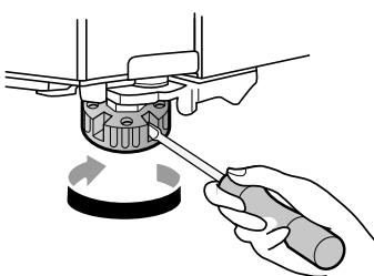
**1** Gire la pata niveladora hacia la derecha para elevar ese lado del electrodoméstico o hacia la izquierda para bajarlo.
