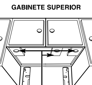
BLOQUES DE RELLENO
