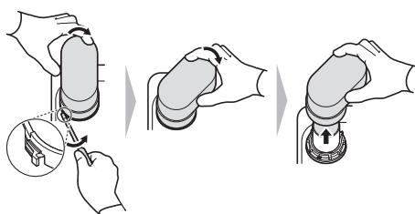
**4** Retire cualquier desecho con un cepillo, si es necesario. La cubierta se puede limpiar con agua potable. Déjela secar antes de volver a colocarla para evitar que ingrese agua a la tubería del soplador.
