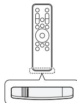
Utilice una pila de botón CR2025 de 3 V. Sustituya la pila por una nueva e insértela en la bandeja de las pilas tal y como se muestra.
