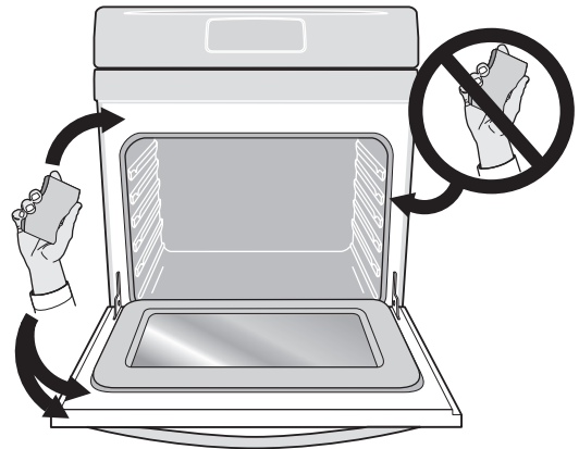
Figure 8: Nettoyer le pourtour du joint de la porte du four
