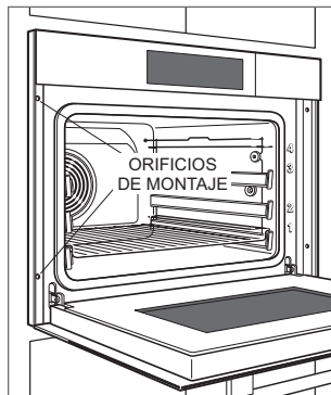
Instalación del horno
