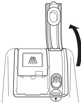
**2** Agregue líquido abrillantador hasta el nivel máximo de llenado. Permita que el abrillantador se asiente en el dispensador mientras se llena o pueden formarse burbujas de aire que producirán resultados deficientes de secado. Evite llenar el dispensador en exceso.
