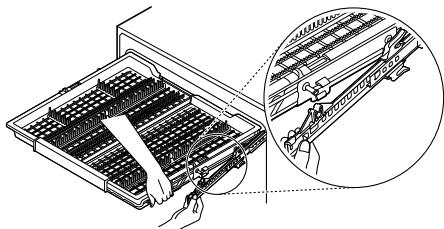
**4** Para remplazar el estante, coloque los soportes del estante trasero detrás de los ganchos laterales y empújelo hacia adelante para cazar los soportes en los ganchos. Luego
