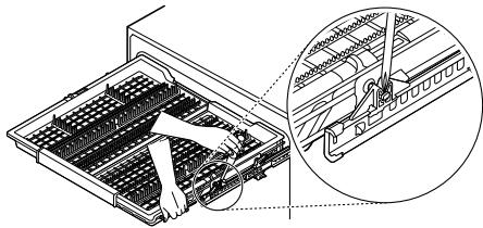
**3** Para remover los soportes traseros del estante de los rieles, sostenga un riel lateral con una mano, levante el frente del estante, y empújelo de nuevo firmemente para desencajar el soporte de los ganchos en la parte trasera. Repita en el lado opuesto.
